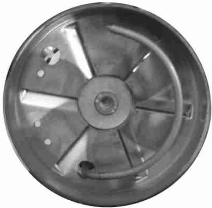
Abb. 4: Position Ionisationselektrode (Abstand zur Stauscheibe 4-5 mm)
