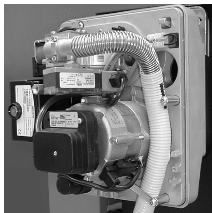
Abb. 9: Gasschlauch hinter den Schlauchhaltern verlegen und mit Schlauchschelle sichern.
