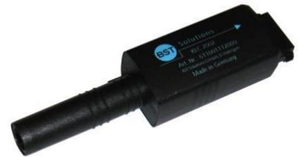
Der KLC 2002 (G) bewertet nur das Flackern der zu überwachenden Flamme. Optional ist eine Geräteausführung mit Störfrequenzabblendung erhältlich. Gleichlichtstrahlungen und jegliche konstanten Frequenzen führen hierbei nicht zu einer dauerhaften Flammenerkennung. Störende Fremdlichtquellen, z.B. von Leuchtstoffröhren oder niederfrequente Hintergrundstrahlungen von glühenden Ausmauerungen, werden ausgeblendet. Ungewollte Beeinflussungen der Flammenerkennung können hierdurch vermieden werden.
